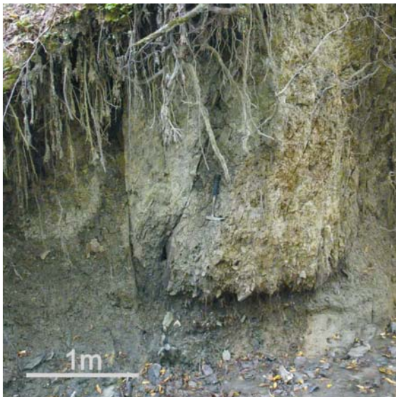
Obr. 2: Polygenetické svahové hliny s úlomkami pieskovcov (pleistocén – holocén) segmentované zlomovými poklesovými štruktúrami. Smer a veľkosť sklonu zobrazených štruktúr je 94/81° a 88/69°.
